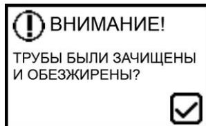
Устройство напомнит оператору о необходимости удаления оксидного слоя и последующего обезжиривания свариваемых элементов.
