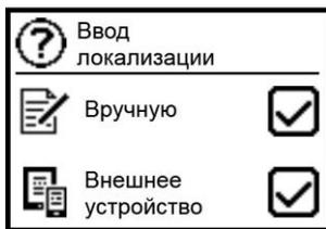
У оператора есть возможность ввести координаты GPS. Они могут быть введены с внешнего GPS-устройства, которое отправит данные GPS сварочному аппарату (доступно только для пользователей приложения SMART WELD), либо вручную.
