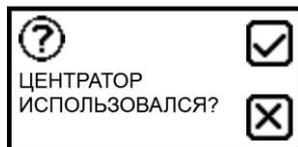
Устройство запросит, был ли использован позиционер для фиксации конструкции труба-фитинг в процессе сварки. Эта информация также будет отображена в протоколе.
