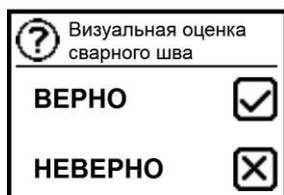
По завершении процесса охлаждения устройство запросит у оператора визуальное подтверждение выполненного соединения. Проверьте индикаторы расплава на фитинге и подтвердите наблюдения:
