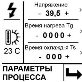
**F1**-> Регулируйте напряжение сварки с помощью "+" и "-". Значение меняется на 0,1 В, удерживание кнопки дольше изменит значение на 1 В.
