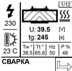
Электродуговая сварка в процессе. Экран отображает информацию о его текущих параметрах: оставшееся время сварки, напряжение и наружная температура, частота тока и процент использования трансформатора.
